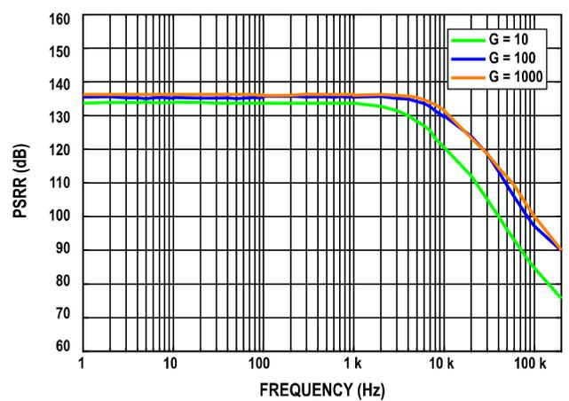
图11. 正 PSRR 与频率的关系, RTI ( $G = 10$  至 1000)
