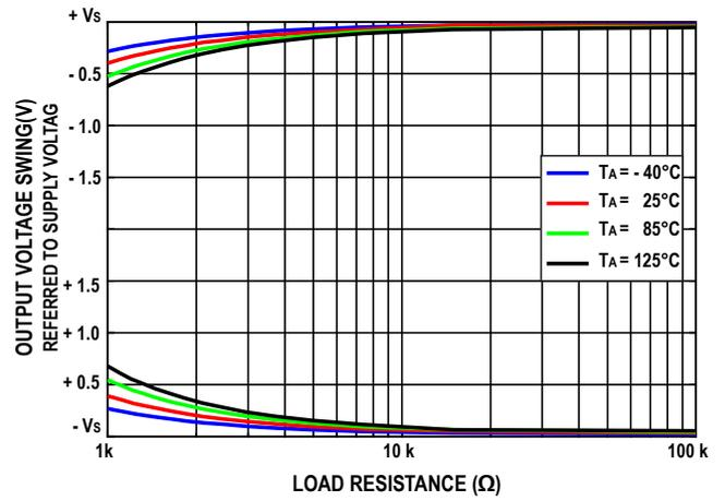
图15. 输出电压摆幅与负载电阻的关系
