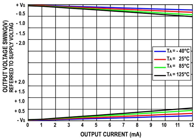
图18. 输出电压摆幅与输出电流的关系
