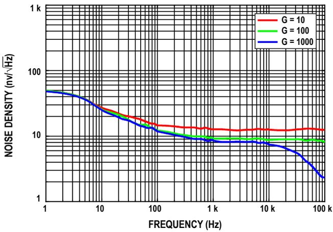
图20. 电压噪声谱密度与频率的关系 (G = 10 至 1000)
