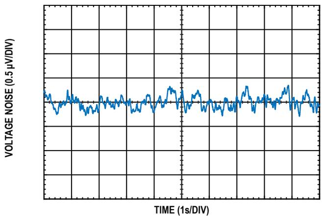
图19. 0.1 Hz 至 10 Hz RTI 电压噪声 ( $G = 100$ )
