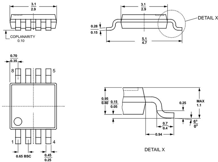
图38. MSOP-8 封装尺寸图 (单位: 毫米)
