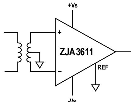
图28. ZJA3611 与变压器的连接
