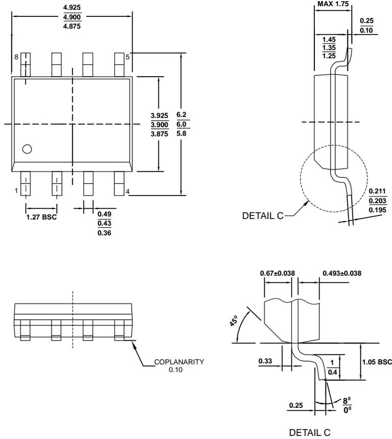
图37. SOIC-8 封装尺寸图 (单位: 毫米)
