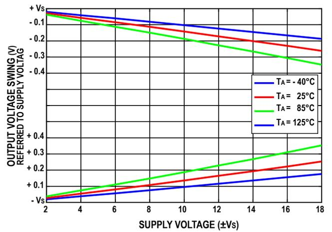
图17. 输出电压摆幅与电源电压的关系 ( $R_L = 2\text{ k}\Omega$ )
