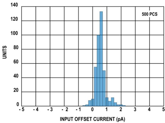
图8. 输入失调电流  $I_{OS}$  的典型分布图
