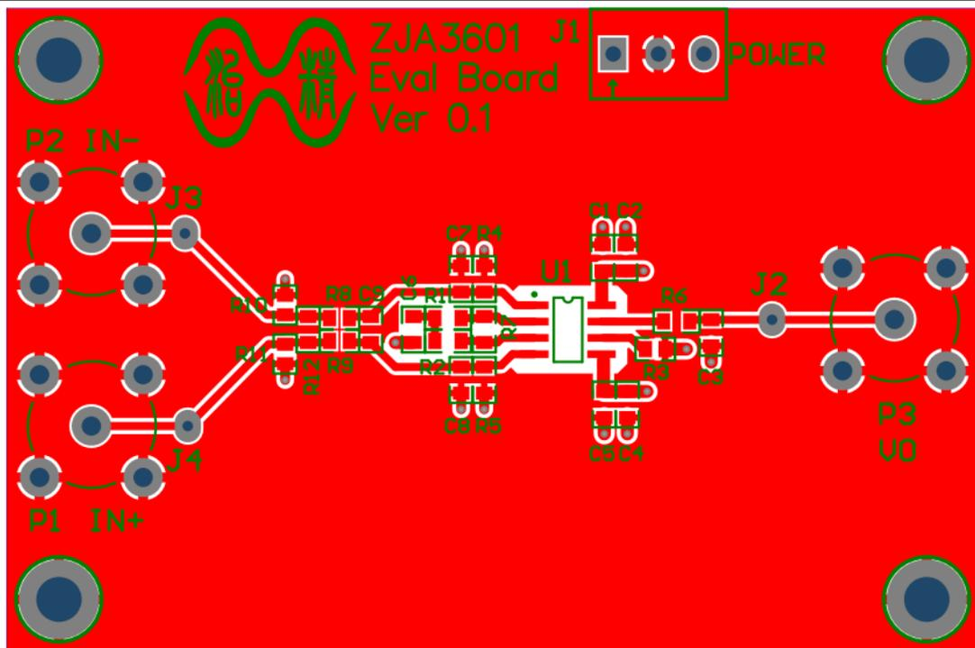
图35. ZJA3601/3611 评估板 PCB 顶层设计
