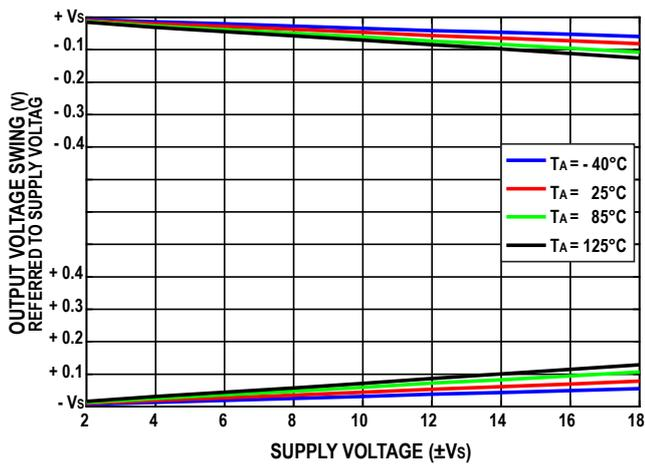
图16. 输出电压摆幅与电源电压的关系 ( $R_L = 10\text{ k}\Omega$ )
