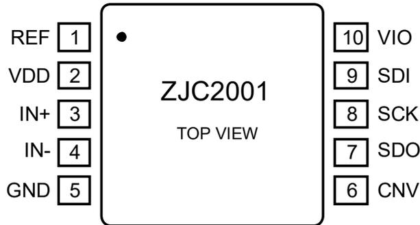
图 3. 10 引脚 MSOP 管脚配置图
